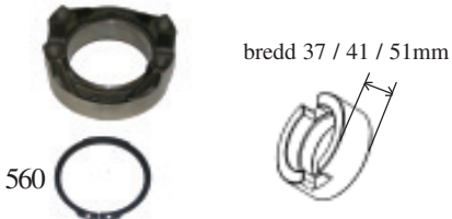
530. Medbringare - bredd 37mm upp till chassienr. 664. 540. Medbringare - bredd 41mm upp till chassienr. 2184. 550. Medbringare - bredd 51mm från chassienr. 2185. 560. Segersäkring.
